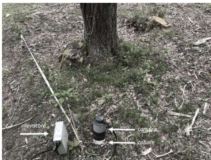
Fig. 9. Localizzazione dei tre siti monitorati per le emissioni di CO 2 dal suolo nel periodo giugno-luglio 2019 presso l'azienda TIZ (in alto) ed esempio di esecuzione della misurazione
